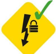
Antes de iniciar los trabajos verifico la ausencia de cualquier tipo de energía (mecánica, química, eléctrica, fluidos a presión, etc.)
