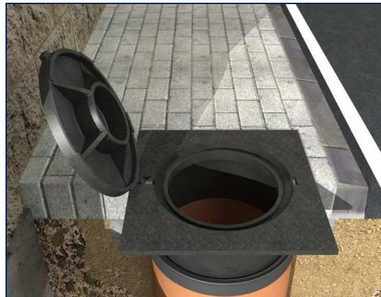
La arqueta, realizada por cuenta del usuario, se ubicará junto a la fachada del inmueble, o límite de la parcela de la edificación y será prefabricada, con articulación mecánica y junta de goma,
