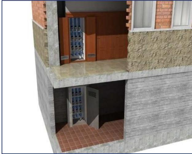
En los casos en los que la batería de contadores se ubique a más de 5 metros de la línea de fachada, se deberá dejar instalada en la fachada una caja de contador homologada por EMUASA con contador sustractivo.
