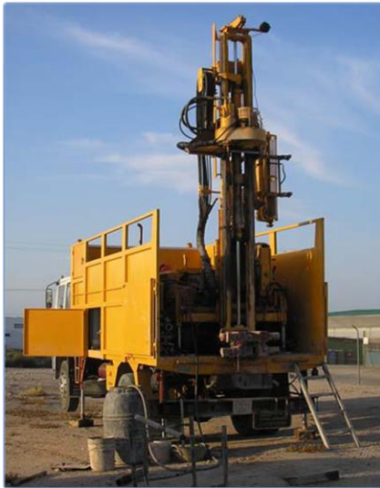
Imagen 89 Ejemplo de preparación de maquinaria para sondeo
