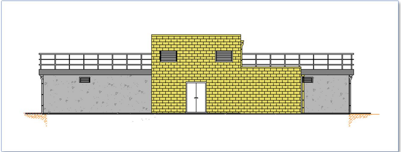
Imagen 30 Vista frontal de acceso a cámaras desde sala de válvulas en depósito existente.
