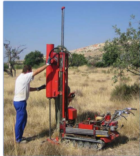
Imagen 90 Ejemplo de penetrómetro para sondeo
